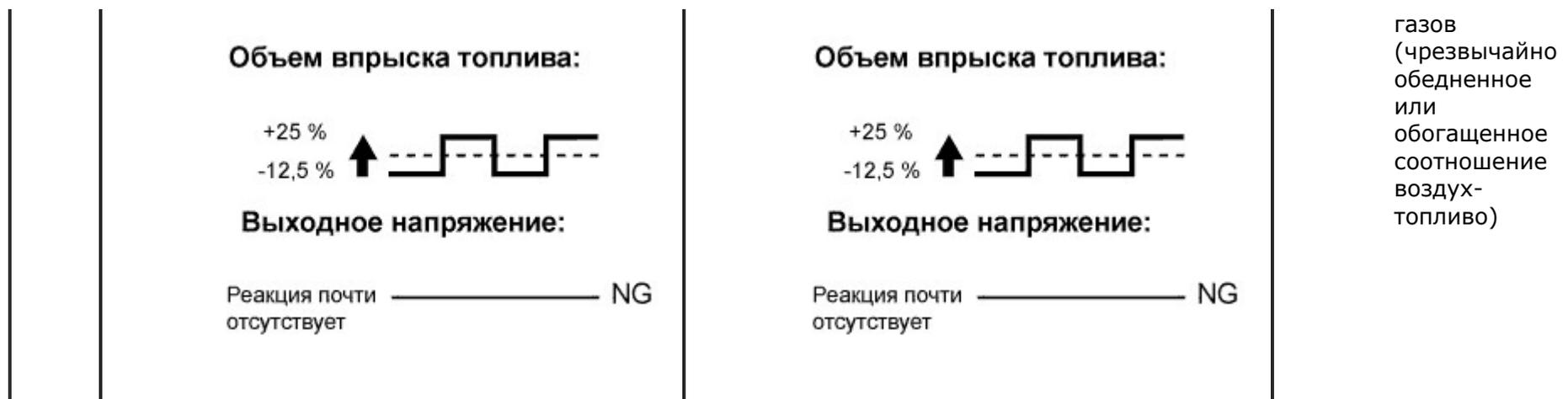
Рассмотренное испытание "Control the Injection Volume for HO2 Sensor" дает возможность механикам выполнить измерения и построить графики выходных напряжений обоих подогреваемых кислородных датчиков.
